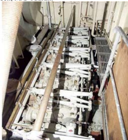
M/S Alpon pääkone Atlas Imperial, 6-sylinteriä, 400 hv ja 300 l/min
